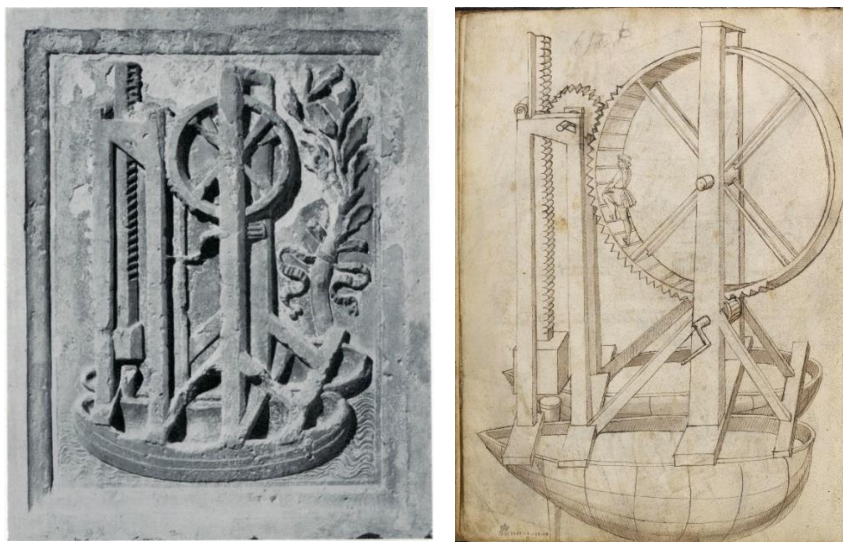
Fig. 1 Formella raffigurante un battipalo azionato da una ruota calcatoria [in Bernini Pezzini (1985, 209)], da Francesco di Giorgio Martini, Opusculum de architectura , ms., c. 1475-1478, Londra, British Museum, Ms. 197.b.21, c. 48v
