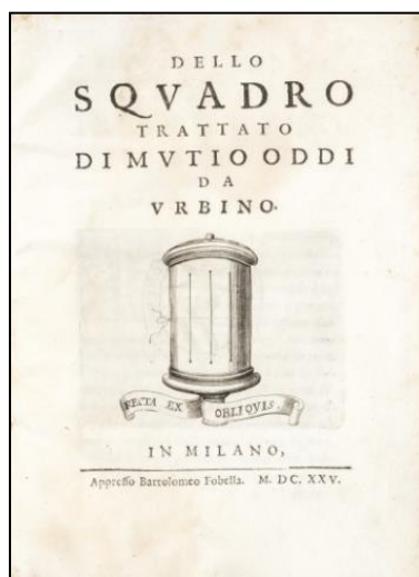
Fig. 8 M. Oddi, Dello squadra , Milano 1625, visibile la forma cilindrica ad otto fenditure dello strumento di rilevamento.
