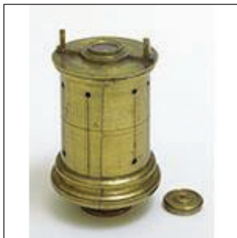
Fig. 9 Museo Galileo Firenze, Squadro agrimensorio, firmato Urbino 1654, ottone, 150x60 mm.
