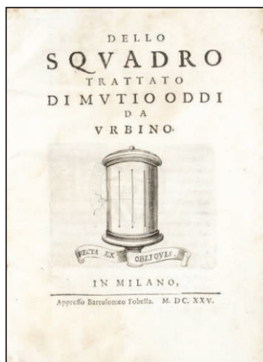
Fig. 8 M. Oddi, Dello squadro , Milano 1625, visibile la forma cilindrica ad otto fenditure dello strumento di rilevamento.
