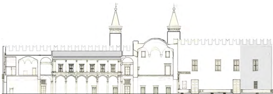
V 1.2 Progetto Laurana: facciata del Castellare (del prospetto ad ali) con sezione della sala del Trono e facciata occidentale del cortile d'Onore.
