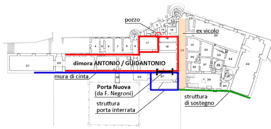
III 2.26 Pianta primo seminterrato, ex dimora di Antonio/Guidantonio con indicato il pozzo di alimentazione dei piani superiori e la porta nuova di tipo interrato.
